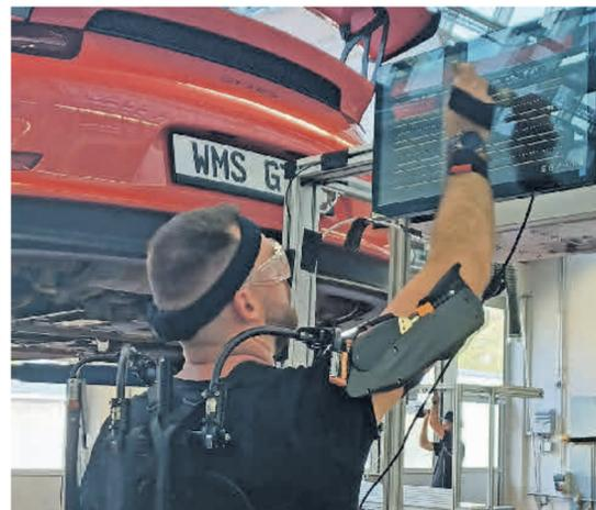
**Lacksimulator:** Die „Pinselstriche“ gilt es über Kopf gleichmäßig auf dem Touchpad zu applizieren. Jede kleine Abweichung wird registriert. Foto: Fraunhofer IPA
