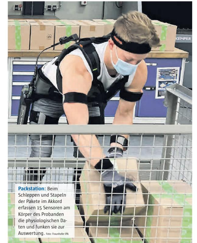
**Packstation:** Beim Schleppen und Stapeln der Pakete im Akkord erfassen 15 Sensoren am Körper des Probanden die physiologischen Daten und funken sie zur Auswertung. Foto: Fraunhofer IPA
