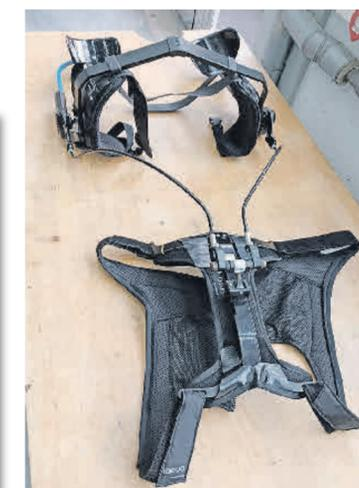
**Anprobe:** Dieses passive, also nicht motorgetriebene Exoskelett von Laevo unterstützt die Probanden an der Packstation. Foto: Bettina Reckter
